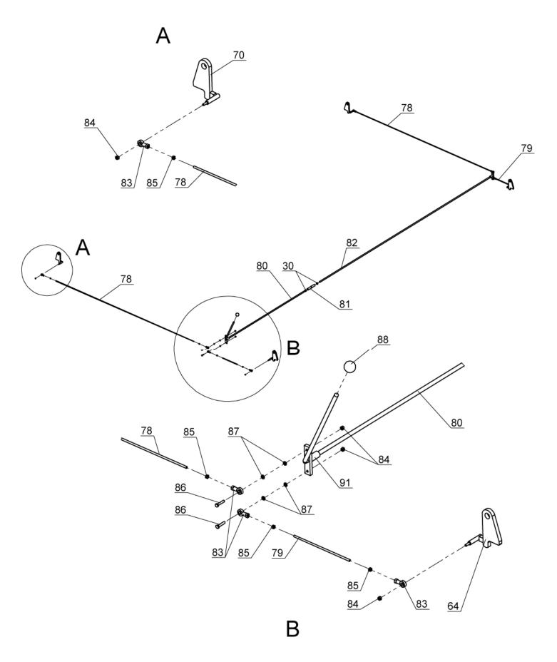
SAFETY LATCH & LINKAGE COMPONENTS - FIGURE # 5
