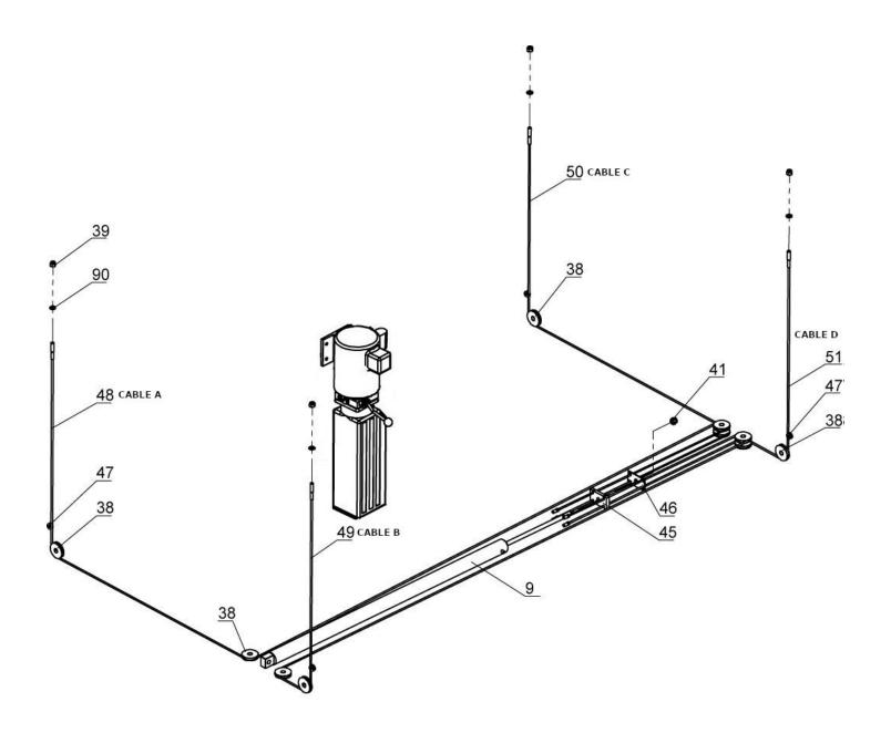
CABLE COMPONENTS & ROUTING - FIGURE # 3
